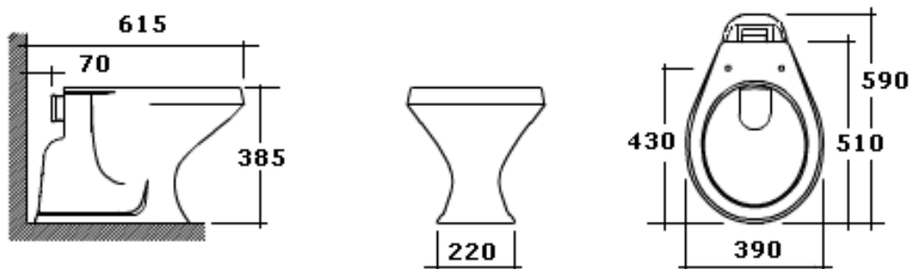
Bacia convencional Dimensões em milímetros
